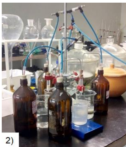
Figura 17 - Sistema de extração para SPE (aparatado extrator) utilizado no LAMAG/UFPA.
